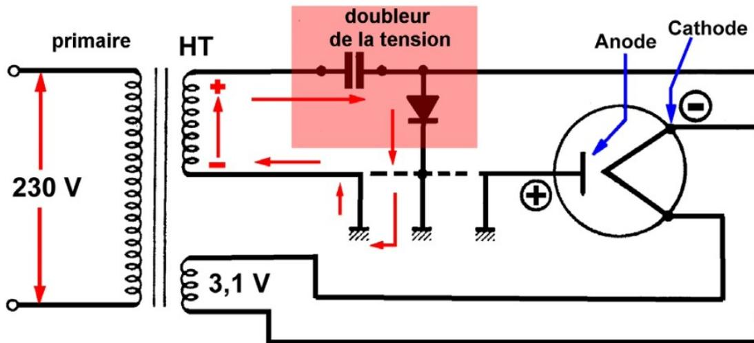
On charge le condensateur qui monte à plus de 2000 V, en utilisant la HT du transfo.
