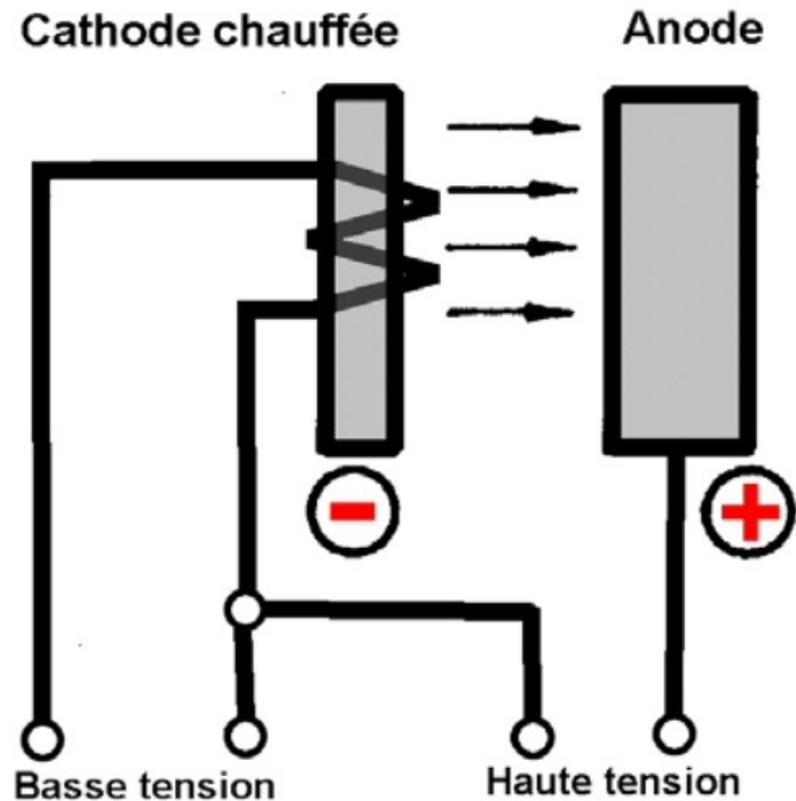
En passant de la cathode à l'anode, les électrons vont générer des OEMs
