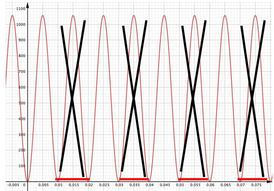
La moitié des cycles la tension est annulée à cause de la diode qui bloque le courant électrique
