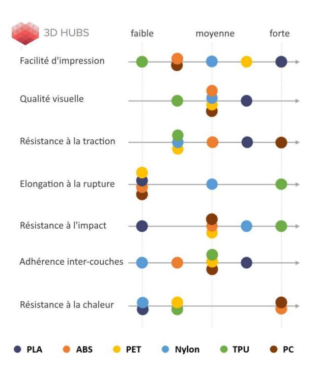
PLA prototypage et figurines, ABS tenu chaleur, TPU pièce déformable, Nylon résistance chimique.
