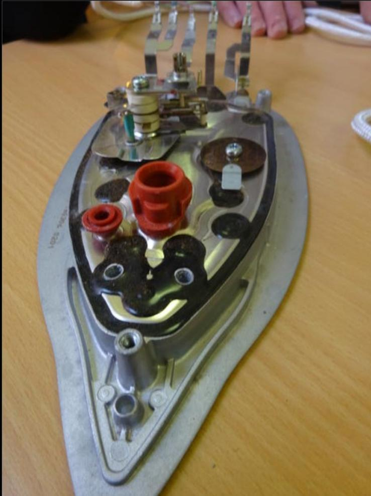
Contact de l'interrupteur du thermostat
