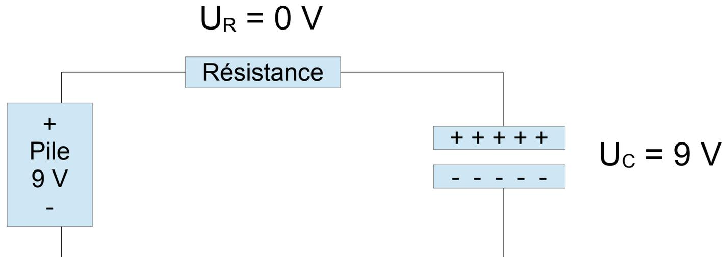
Au final, la tension aux bornes du condensateur vaut 9 V. Donc celle aux bornes de la résistance est nulle et d'après la loi d'Ohm l'intensité aussi. Il ne se passe plus rien. Le condensateur se comporte comme un circuit ouvert.
