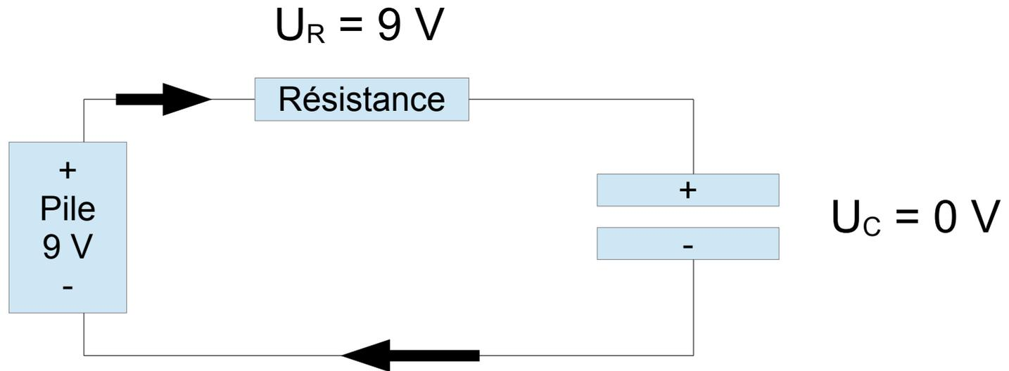
Au début, le condensateur est comme un court-circuit, l'intensité est  $U/R$ . La plaque 1 commence à se charger de charges positives venant du pôle + de la pile. De l'autre côté, pour garder la neutralité, la plaque 2 se charge négativement.
