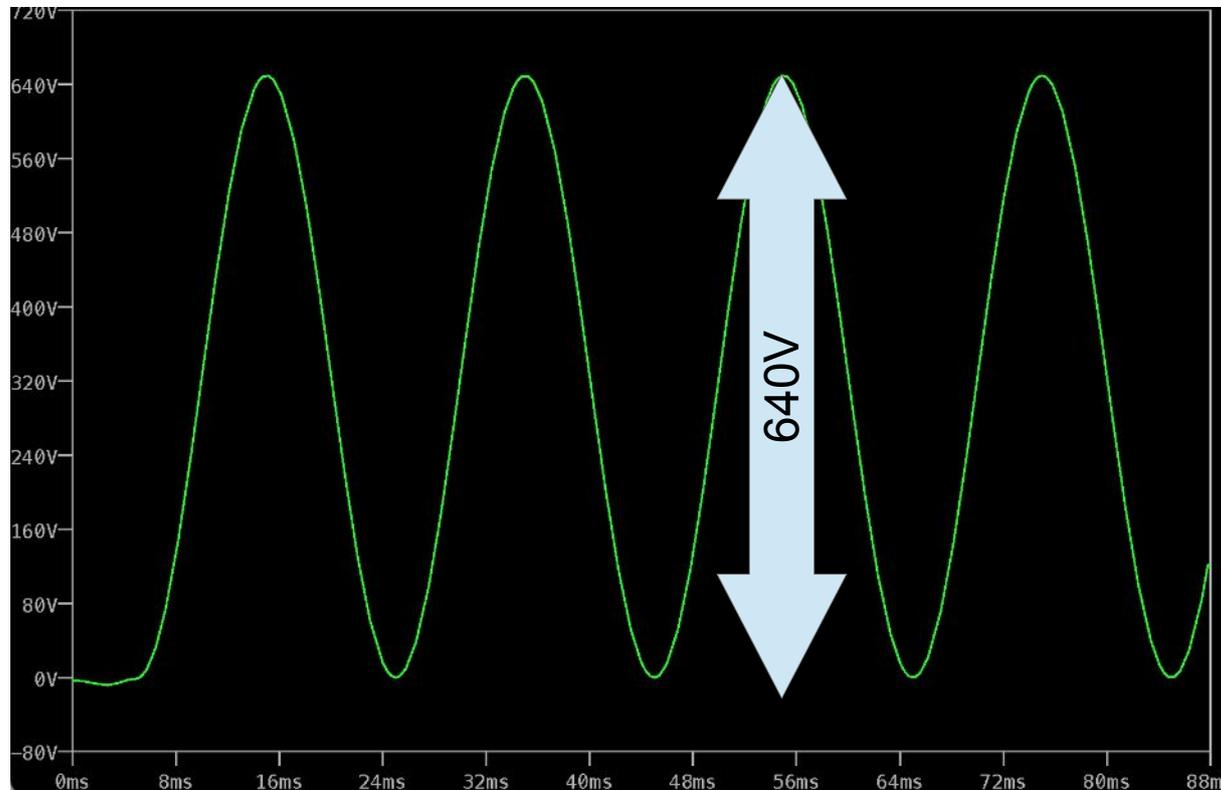
Pour le même circuit, tension aux bornes de la diode
