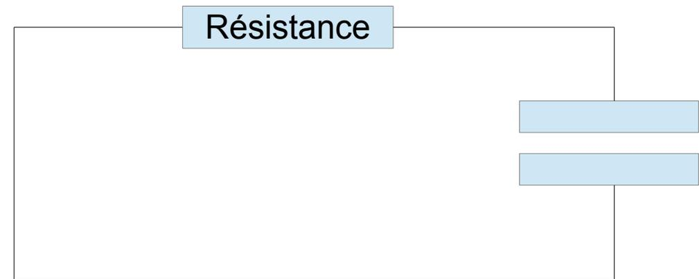
Le condensateur va jouer le rôle d'une petite pile. Le courant va dans le sens inverse du fait des polarités. Les charges positives s'annulent avec celles négatives. Après un moment le condensateur n'a plus de charge, il n'y a donc plus de mouvement, plus d'intensité.
