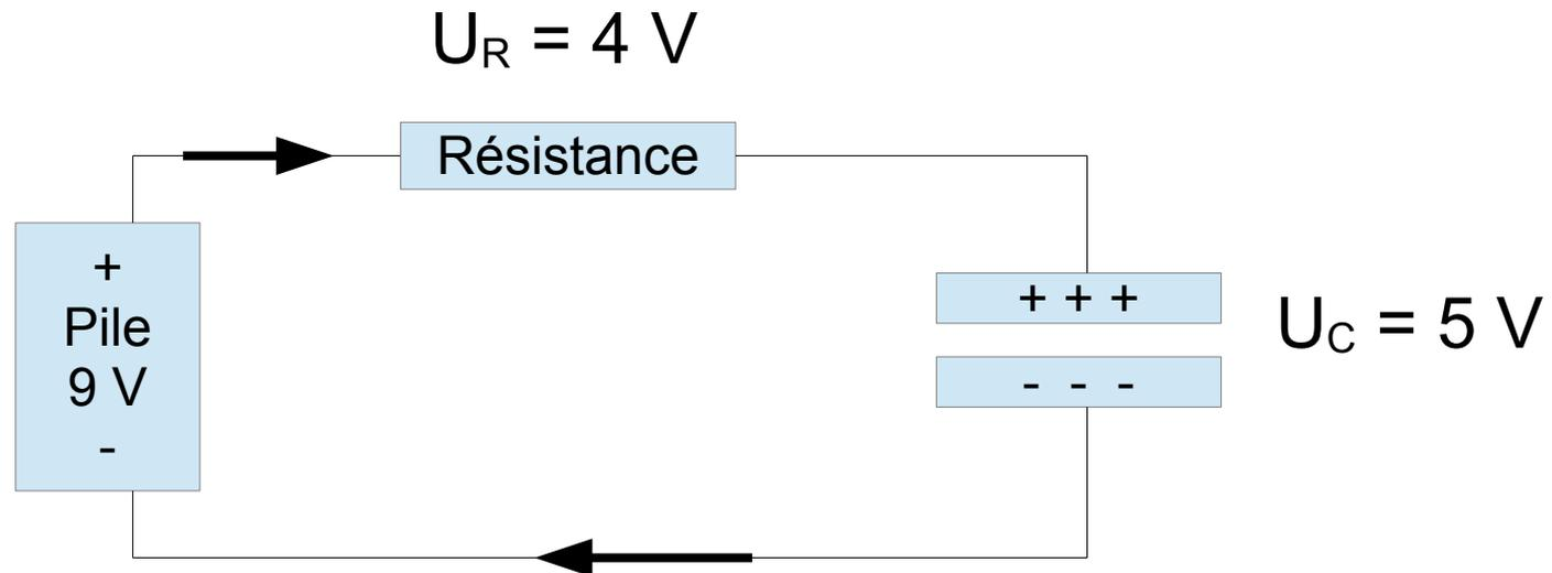
Au fur et à mesure, le condensateur se charge, la tension à ses bornes grandit. Donc la tension aux bornes de la résistance diminue ainsi que l'intensité.
